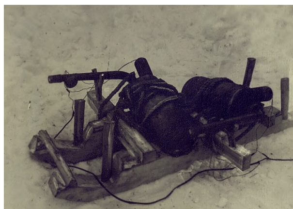
Рисунок 1 – Фугасные огнеметы ФОГ-1 на самодельных салазках. Закреплены и подключены (фотография – зима 1941–1942 гг. ЦАМО. Ф. 74. Оп. 12308. Д. 111. Л. 24)
