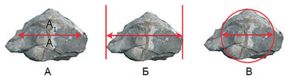
Рисунок 3 – Сравнение некоторых эквивалентных диаметров частицы произвольной формы в схематическом представлении в порядке возрастания [36]. А – Диаметр Мартина (длина хорды, разделяющей проекцию частицы на две части, имеющие равные площади A1 и A2); Б – Диаметр Ферета (расстояние между параллельными линиями, касательными к линии контура проекции частицы); В – Диаметр Хейвуда (диаметр окружности, имеющей ту же площадь, что и проекция частицы) Figure 3: Comparison of some equivalent diameters of a particle of arbitrary shape in a schematic representation in ascending order [36]. A, Martin diameter (length of the chord dividing the particle into two parts having equal areas A1 and A2); Б, Feret diameter (distance between parallel lines tangent to the contour line of the particle); В, Heywood diameter (diameter of a circle having the same area as the projection of the particle)
