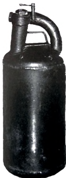
Рисунок 4 – Советский фугасный огнемет ФОГ-2 (рисунок адаптирован авторами из [2])
