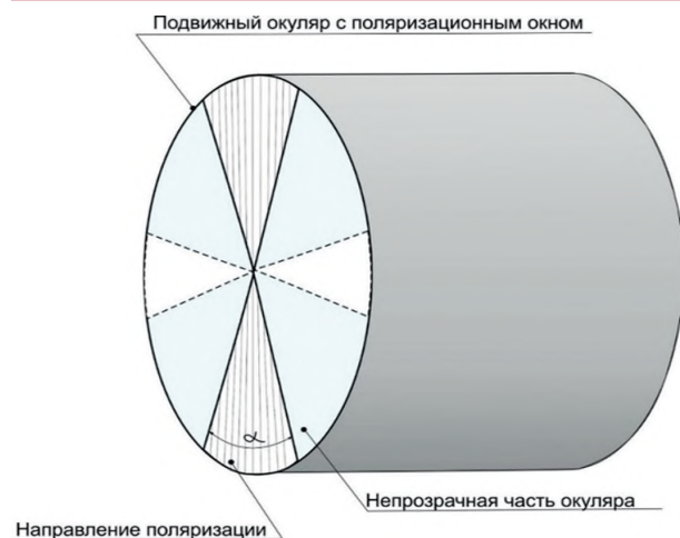
Рисунок 4 – Схема поляризационного фотоприемного окна светового потока после аэрозольной камеры (рисунок авторов)
