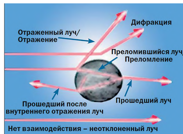
Рисунок 7 – Схемы взаимодействия электромагнитного излучения со сферическим объектом в представлении геометрической оптики [34]
