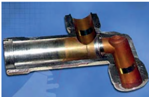
Рисунок 3 – Элемент узла атомной субмарины после лазерной дезактивации (рисунок подготовлен авторами по [8])
