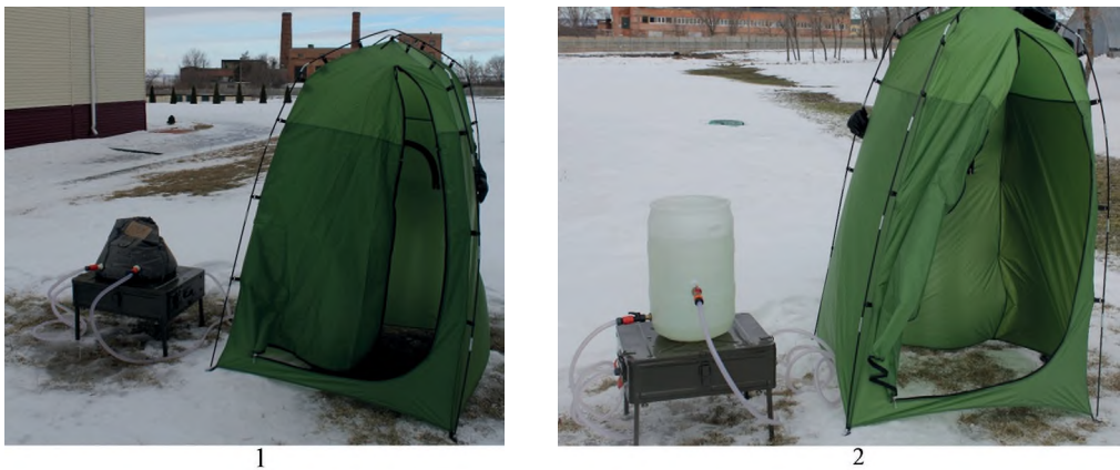
Рисунок 13 – Внешний вид комплекта санитарной обработки KSanO в развернутом положении: 1 – вариант 1 (с емкостью РДР-40); 2 – вариант 2 (с пластиковой бочкой на 50 л). Авторство изображения принадлежит ФГБУ «33 ЦНИИИ» МО РФ (представлено разработчиками комплекта) Figure 13: A sanitizing kit KSanO. The figure is borrowed from 33 Central Scientific Research Test Institute, MD RF (provided by the developers of the kit)
