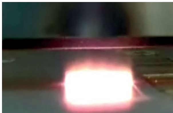
Рисунок 5 – Ионизированный газ, образующийся при лазерной очистке поверхности (рисунок подготовлен авторами по [17])
