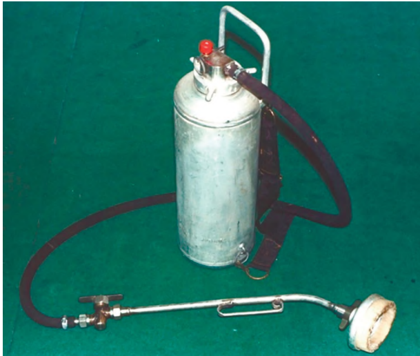
Рисунок 11 – Внешний вид прибора АПСО. Авторство изображения принадлежит ФГБУ «33 ЦНИИИ» Минобороны России Figure 11: ISTD (Independent special treatment device). The figure is borrowed from 33 Central Scientific Research Test Institute, MD RF
