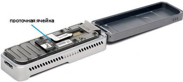
Рисунок 1 – Нанопоровый секвенатор MinION. Управление и получение данных осуществляется с помощью смартфона (URL: https://www.skygen.com/katalog/oborudovanie/oxford_nanopore_technologies/nanoporovyy_sekvenator_minion/ ; дата обращения: 07.07.2023)
