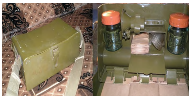
Рисунок 7 – Прибор химической разведки ПХР-46 (фотография из архива ФГКВООУО «ВА РХБ защиты» Минобороны России)
