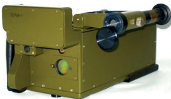
Рисунок 42 – Прибор химической разведки дистанционного действия ПХРДД-3 (фотография из архива ФГКВОУВО «ВА РХБ защиты» Минобороны России)
