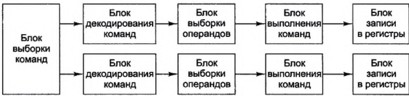
Рисунок 3 – Схема суперскалярной архитектуры с двумя конвейерами
