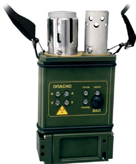
Рисунок 35 – Внешний вид ГСА-3 (фотография из архива ФГКВООУ «ВА РХБ защиты» Минобороны России)
