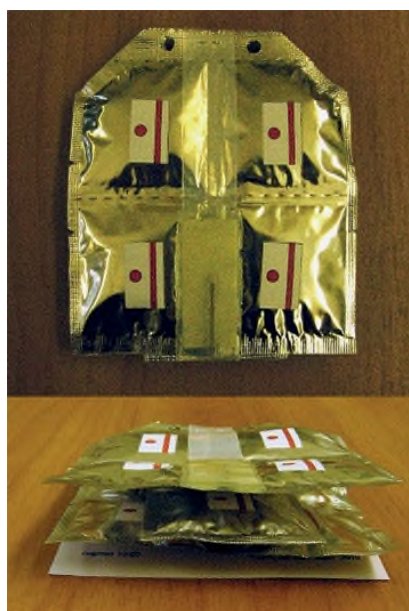
Рисунок 37 – Индикаторные плоские элементы (фотография из архива ФГКВООУ «ВА РХБ защиты» Минобороны России)
