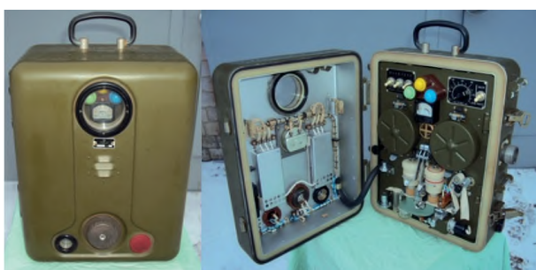
Рисунок 11 – Внешний вид газосигнализатора ГСП-11 (фотография из архива ФГКВУВО «ВА РХБ защиты» Минобороны России)
