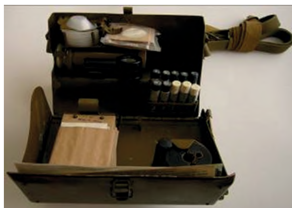
Рисунок 13 – Войсковой прибор химической разведки ВПХР (фотография из архива ФГКВУВО «ВА РХБ защиты» Минобороны России)
