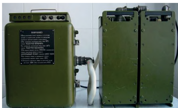
Рисунок 20 – Внешний вид прибора ГСА-12 с блоками питания БП-26 и БП-127/220 (фотография из архива ФГКВООУВО «ВА РХБ защиты» Минобороны России)
