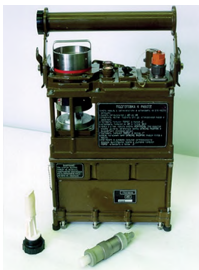
Рисунок 23 – Внешний вид сигнализатора ГСА-1 (фотография из архива ФГКВООУВО «ВА РХБ защиты» Минобороны России)
