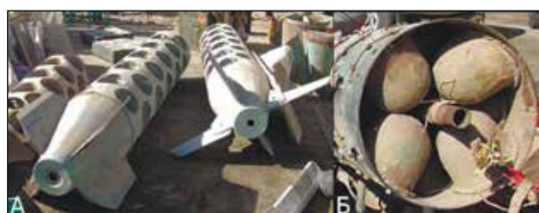
Рисунок 15 – Кассетная бомба Nasr 28 (А. Внешний вид бомбы. Б. Эжекционные камеры для суббоеприпасов) [19]
