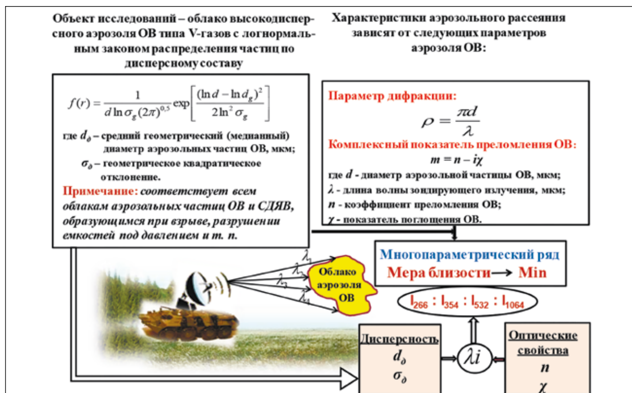
Рисунок 8 – Алгоритм восстановления параметров функции распределения по дисперсному составу аэрозольных облаков V-газов методом многочастотного лазерного зондирования [8]
