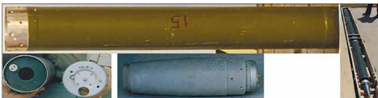
Рисунок 11 – 122-мм химическая ракета «SAKR-30» [19] (показаны: слева – двигательный блок ракеты, одна из секций с ОВ, боевая часть; справа – ракета в сборке)
