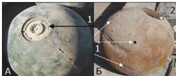
Рисунок 16 – Суббоеприпасы бомбы NASR 28 [19] (А. Стальная сфера 135 мм, покрытая слоем резины толщиной 10 мм с общим диаметром 155 мм. 1 – взрыватель ударного типа. Назначение суббоеприпаса осталось непонятным. Б. 155-мм стальной суббоеприпас, предположительно предназначавшийся для термической возгонки иприта или VX. 1 – отверстия для выхода пара ОБ; 2 – гнездо для взрывателя ударного типа)
