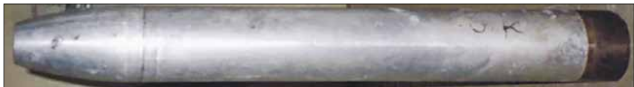
Рисунок 12 – Алюминиевая химическая головная часть типа «аль-Бурак» для 122-мм ракеты [19]
