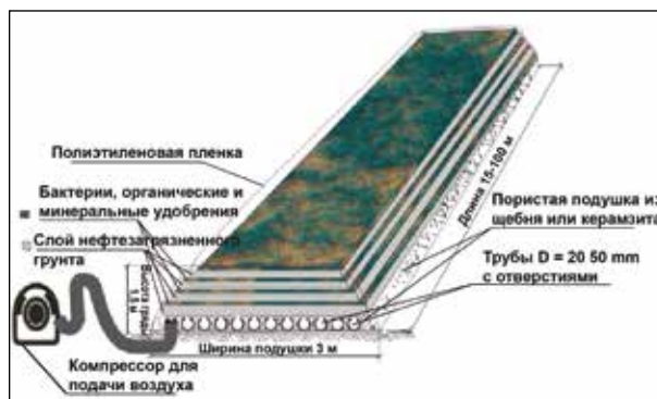
Рисунок 4 – Схема рекультивации нефтезагрязненной почвы [10]
