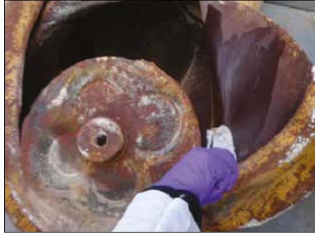
**Рисунок 20** – Чистое от ржавчины отверстие для ввинчивания вентиля, свидетельствующее, что этот баллон не использовался для доставки хлора
