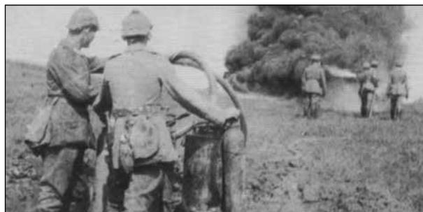
**Рисунок 15** – Повышение дальности выстрела тяжелого огнемёта Гроф путем удлинения шланга, подающего огнесмесь на брандспойт [10]
