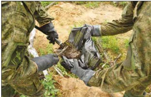
**Рисунок 7 – Отбор грунта при ликвидации локального химического заражения**
