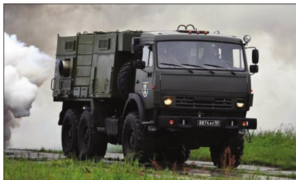
Постановка аэрозольных завес дымовой машиной ТДА-3
