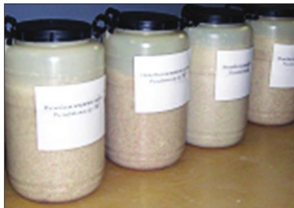
Рисунок 8 — Внешний вид биокатализатора на основе иммобилизованных клеток Pseudomonas sp. 78Г, использованного на пилотной установке с целью обработки реакционных масс, полученных после уничтожения ФОВ
