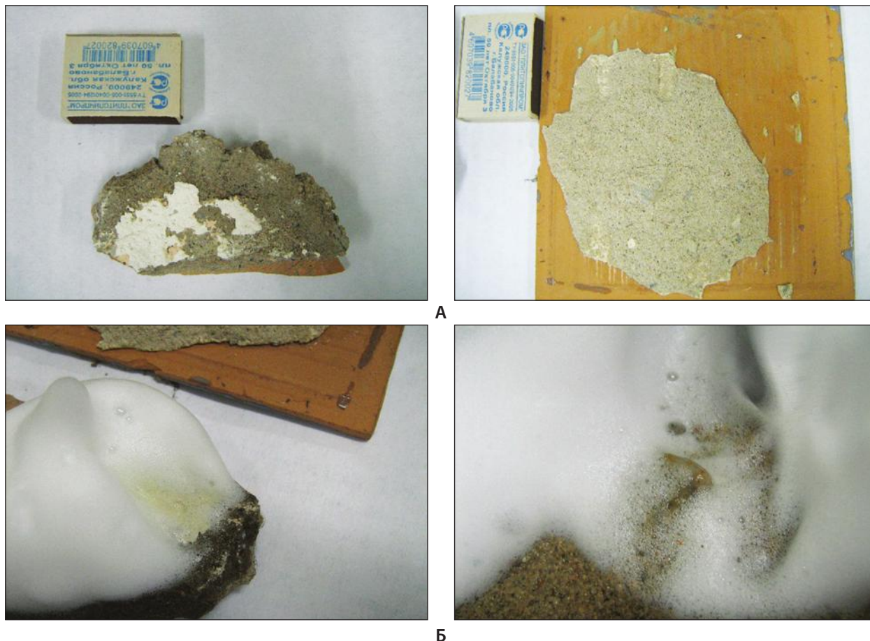
Рисунок 7 — Обработка твердой поверхности фермент содержащим пенным покрытием (А – Образцы штукатурки перед обработкой; Б – Образцы штукатурки после загрязнения параоксоном и обработки пеной с ферментом His 6 -ОФГ, полученной при помощи миксерной технологии)
