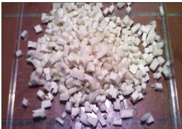
Рисунок 8 — Внешний вид биокатализатора на основе иммобилизованных клеток Pseudomonas sp. 78Г, использованного на пилотной установке с целью обработки реакционных масс, полученных после уничтожения ФОВ
