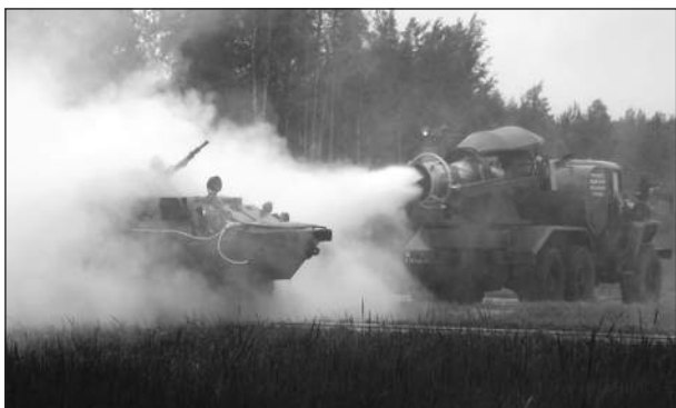
Специальная обработка РХМ-4 тепловой машиной ТМС-65У
