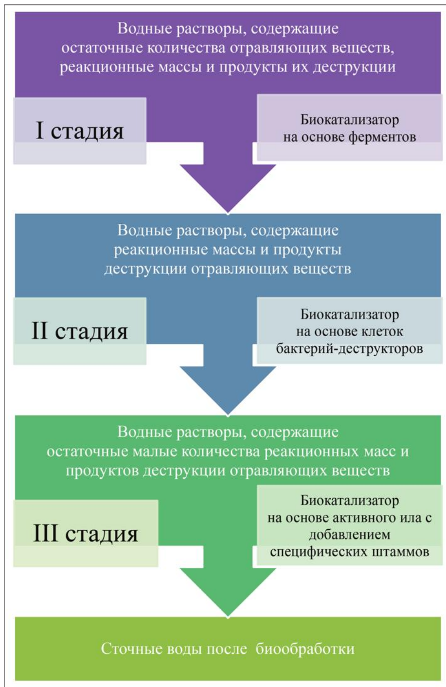
Рисунок 9 — Принципиальная технологическая схема реализации способа биоразложения реакционных масс вещества типа VX
