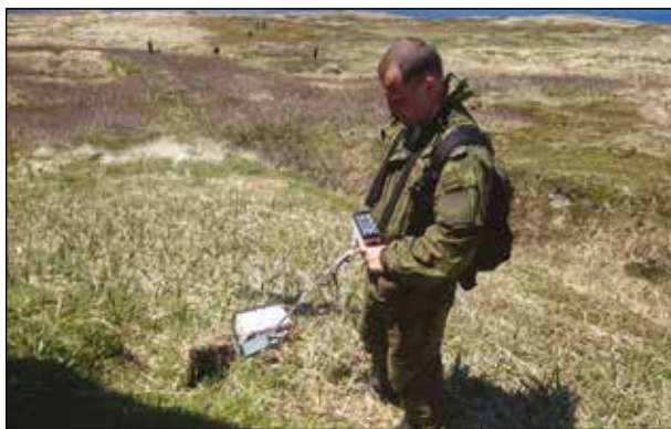
Рисунок 16 — Обследование на наличие радиоактивного загрязнения с помощью прибора радиоизотопной идентификации ИМД-2НМ
