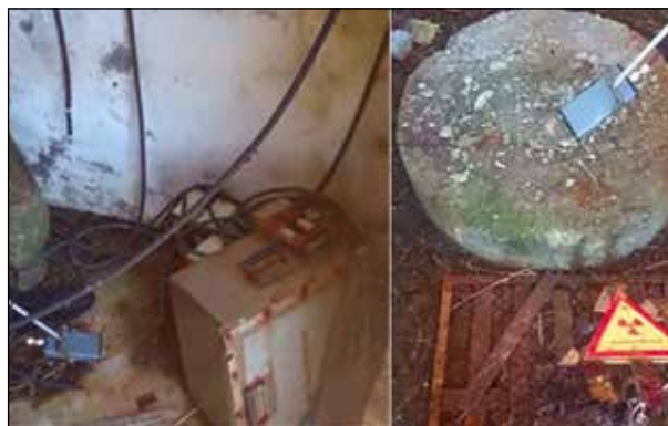
Рисунок 20 — Обследование подвального помещения и демонтированного осветительного оборудования на наличие радиоактивного загрязнения прибором ИМД-2НМ
