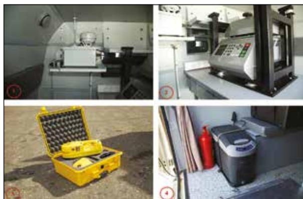
**Рисунок 19** — Оборудование машины МБР (1 – Сигнализатор биологических угроз в режиме реального времени ИВАС. 2 – Анализатор нуклеиновых кислот АНК-32. 3 – Пробоотборник аэрозолей BioCapture 650. 4 – Холодильник «IndelB» для хранения наборов реагентов)
