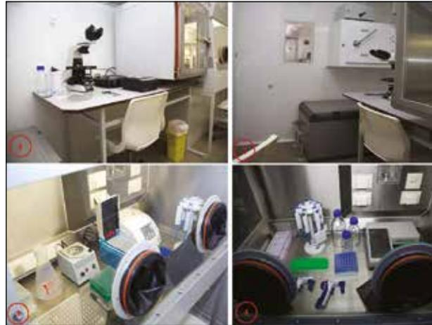
**Рисунок 5** — Рабочие места и боксы модуля МИФА (1 – Рабочее место для проведения микроскопирования. 2 – Передаточный шлюз, холодильник для хранения наборов реагентов. 3 – Бокс биологический 3 класса защиты с приборами для проведения анализа методом ПЦР. 4 – Бокс биологический 3 класса защиты с приборами для проведения анализа методом ИФА)
