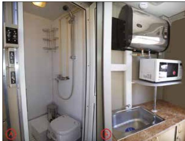
**Рисунок 15** — Бытовой отсек модуля МОИ (А – Гигиенический душ, биотуалет. Б – Место для приготовления пищи (водонагреватель, микроволновая печь, раковина))
