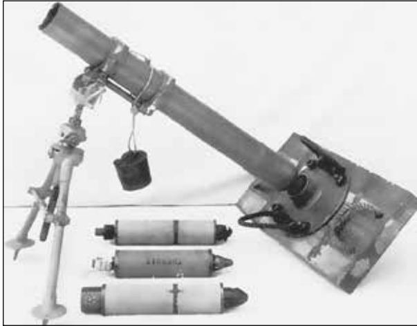
Рисунок 11 — Миномет (мортира) Стокса со всеми принадлежностями для ведения стрельбы (мина снаряжалась 3 кг ОВ (хлор/фосген, хлорпикрин, фосген, этилйодацетат, иприт и др.). Применялся, когда было необходимо сконцентрировать огонь на небольшом пространстве [5])
