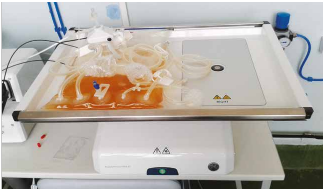
Рисунок 5 — Система культивирования клеток Wave 20/50 (платформа качалки с расположенным на ней одноразовым мешком объемом заполнения 5 л)
