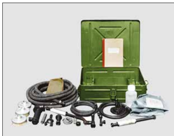
Рисунок 8 — Бортовой комплект специальной обработки (БКСО)
