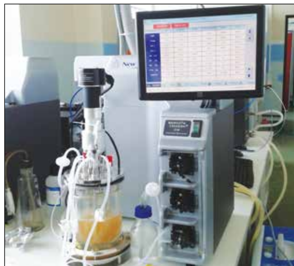
Рисунок 4 — Система суспензионного культивирования на основе ферментеров перемешивающего типа – CelliGen310 (основная станция культивирования и культуральный сосуд с объемом заполнения 1,2 л)
