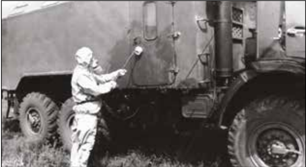
Рисунок 10 — Встроенный прибор специальной обработки (1 — компрессор автомобиля; 2 — рабочая емкость ВПСО; 3 — жидкостный рукав; 4 — ресивер автомобиля; 5 — брандспойт)
