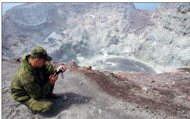
Определение уровня диоксида серы в воздухе на вершине кратера вулкана Сарычева
