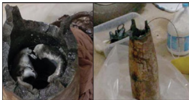
Рисунок 8 – Взорванный американскими саперами 152-мм бинарный зариновый снаряд, заложенный в качестве самодельного взрывного устройства у дороги в «зеленой зоне» багдадского аэропорта. Снаряд обнаружен 16 мая 2004 г. и подорван дистанционно. Образование зарина не произошло. Маркировки на нем нет. Считается, что повстанцы где-то его купили, украли или нашли, и заложили у дороги в аэропорт, предполагая, что это обычный фугасный снаряд. В центре снаряда (фотография слева) виден разрушенный алюминиевый контейнер для прекурсора [23]
