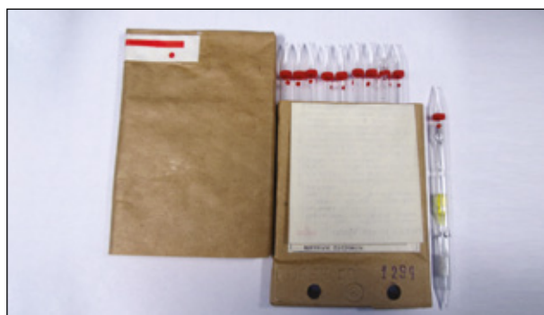
Рисунок 1 – Индикаторная трубка ИТ-44. Принята на снабжение Советской Армии в 1959 г., выпускалась миллионами штук. Ни в одной армии мира в то время не было таких средств индикации ФОВ
