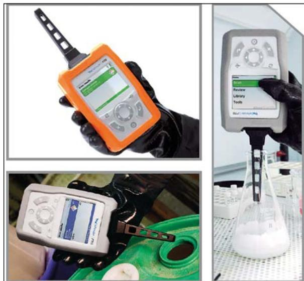
**Рисунок 1 – Портативный инфракрасный Фурье-спектрометр TruDefender FTG. См. Handheld FTIR for Chemical Identification. URL: <https://assets.thermofisher.com/TFS-Assets/CAD/brochures/truedefenderFTG> (дата обращения: 26.08.2020)**
