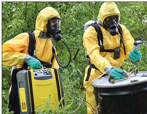
**Рисунок 3 – Инфракрасный Фурье-газоанализатор Gasmet DX4040**
