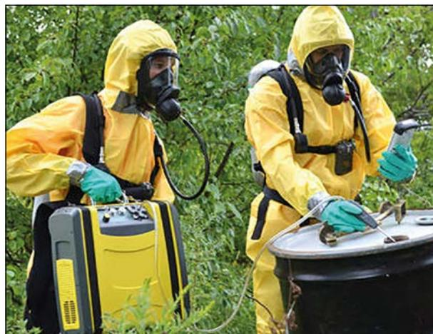
**Рисунок 3 – Инфракрасный Фурье-газоанализатор Gasmet DX4040**
