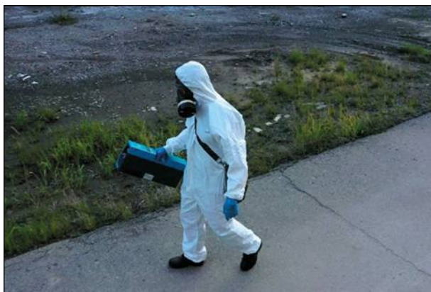
Рисунок 13 – Проведение специалистами войск РХБ защиты ежедневного мониторинга окружающей среды с использованием анализатора ртути РА-915М (октябрь 2020 г., фотографии авторов)
