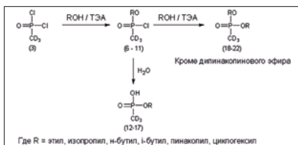
Рисунок 11 – Схема синтеза хлорангидридов эфиров, кислых эфиров и диэфиров дейтерометилфосфоновой кислоты
