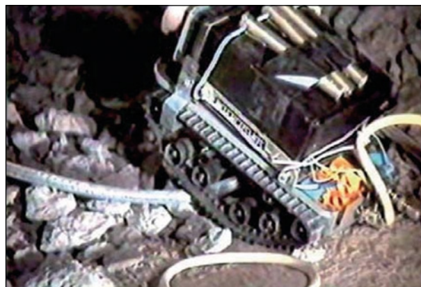
Рисунок 1 – Первый мобильный робот радиационной разведки. Кабель заменили на более длинный, установили на игрушку дозиметр, измеритель температуры и закрепили фонарь [1]
