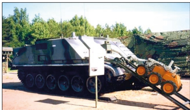
Рисунок 9 – Автономный дистанционно управляемый робот в составе РХМ-7 (фото 33 ЦНИИ МО РФ)
