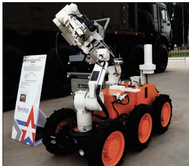
Рисунок 8 – Робот дистанционный радиационной и химической разведки (фото: В.А. Карпенко bastion-karpenko.ru/index ВТС БАСТИОН)
