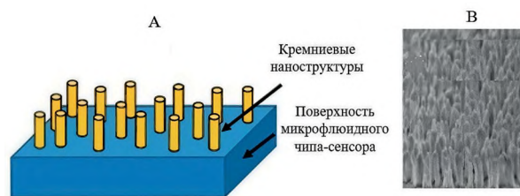
Рисунок 11. Структура «нанолеса»: А – графическая схема; В – электронная микрофотография [31] Figure 11. Structure of the “nanoleaf”. A, Graphical scheme; B, Electron micrograph [31]
