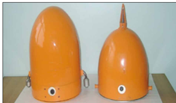
Рисунок 13 – Беспилотный летательный аппарат «Пчела» (А); целевые нагрузки воздушной радиационной и химической разведки (Б) (URL: https://doi.org/10.35825/2587-5728-2021-5-1-71-82 ; дата обращения: 07.05.2022)
