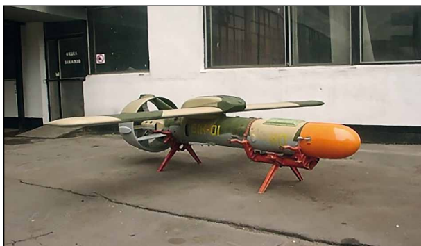
Рисунок 13 – Беспилотный летательный аппарат «Пчела» (А); целевые нагрузки воздушной радиационной и химической разведки (Б) (URL: https://doi.org/10.35825/2587-5728-2021-5-1-71-82 ; дата обращения: 07.05.2022)
