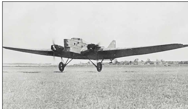
Рисунок 1 – Двухмоторный бомбардировщик ТБ-1 конструкции А.Н. Туполева с дистанционным управлением (URL: https://topwar.ru/137169-otechestvennaya-bespilotnaya-aviaciya-chast-1.html ; дата обращения: 24.05.2022)
