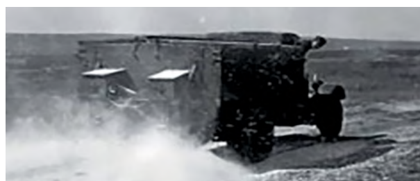
Рисунок 6 – Автодегазатор хлорной извести АХИ на базе шасси АМО проходит испытания в Шиханах, 1936 г. (фотография из архива 33 ЦНИИИ МО РФ)
