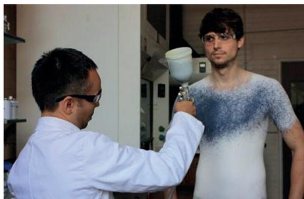
**Рисунок 1** – Нанесение на тело человека нетканой ткани при помощи распылителя с добавлением различных красителей (рисунок адаптирован из Жидкая паутина: как работает технология одежды «из баллончика». URL: <https://www.m24.ru/articles/nauka/03102022/507591>; дата обращения: 16.09.2024)
