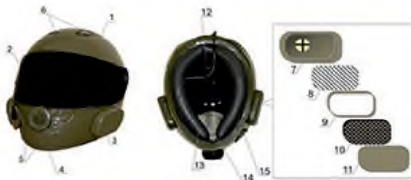
Рисунок 8 - Конструкция противогаза-бронешлема 2-го поколения (рисунок выполнен авторами): 1 - корпус бронешлема; 2 - защитное стекло; 3 - фильтрующе-поглощающие коробки с изолирующей полимерной крышкой-накладкой; 4 - клапан выдоха; 5 - нижние воздухозаборники; 6 - верхние воздухозаборники; 7 - гнездо ФПК с клапаном вдоха; 8 - нетканый материал; 9 - корпус фильтрующе-поглощающего элемента; 10 - фильтрующе-сорбирующий слой ФПЭ; 11 - изолирующая полимерная крышка-накладка ФПК; 12 - фильтрующе-сорбирующий слой в затылочной части шлема; 13 - пневматический obturator; 14 - подмасочник; 15 - приспособление для подключения к ФВУ
