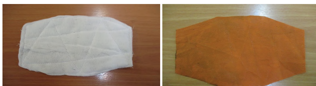
Рисунок 5 – Варианты сменных вкладышей для специальной защитной маски многоразового использования кратковременного действия на основе марли (слева) и длительного действия на основе металлических нанокompозитов (справа) (фотографии выполнены авторами)
