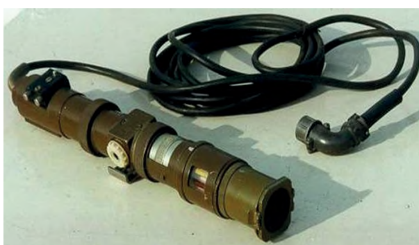
Рисунок 13 – Войсковой прибор химической разведки ВПХР (фотография из архива ФГКВУВО «ВА РХБ защиты» Минобороны России)
