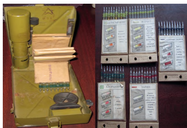
Рисунок 7 – Прибор химической разведки ПХР-46 (фотография из архива ФГКВООУО «ВА РХБ защиты» Минобороны России)
