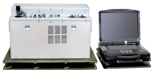
Рисунок 36 – Аналитический блок МХМС на амортизационной платформе и ПЭВМ (фотография из архива ФГКВУВО «ВА РХБ защиты» Минобороны России)
