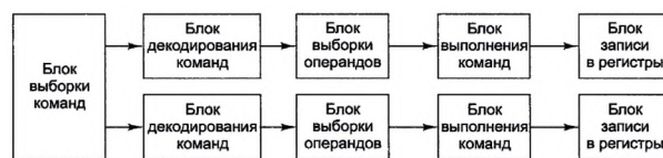
Рисунок 3 – Схема суперскалярной архитектуры с двумя конвейерами
