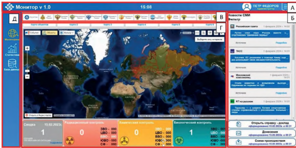
Рисунок 6 – Вариант интерфейса перспективной автоматизированной системы мониторинга РХБ обстановки (рисунок авторов). А – модуль учетной записи; Б – новостной модуль; В – модуль взаимодействия с федеральными органами исполнительной власти; Г – геоинформационный модуль; Д – модуль управления системой базы данных
