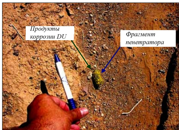
Рисунок 5 – Фрагмент разбившегося пенетратора из DU в почве Испытательного полигона Юма (Yuma Proving Ground, YPG) в Западной Аризоне. Характерный вид: тонкий стержень (немного толще авторучки), покрытый желтыми продуктами коррозии DU. Желтый цвет ему придают шозонит и меташозонит – гидратированные оксиды урана(VI). Благодаря примеси титана, коррозия развивается локальными участками на поверхности пенетратора [28]
