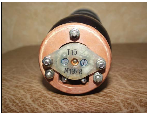
Рисунок 3 – Контрольный источник типа «Бленкер» Т-15, размещенный внутри блока детектирования приборов ИМД-21Б (БА, С, СА, СА-Р), ИМД-22 (БА, СА) (URL: http://im13.rhbz.org/albums/userpics/10001/cfSwXNQDNF8.jpg , http://im13.rhbz.org/albums/userpics/10001/xqxlG6mmUHU.jpg ; дата обращения: 17.06.2022)
