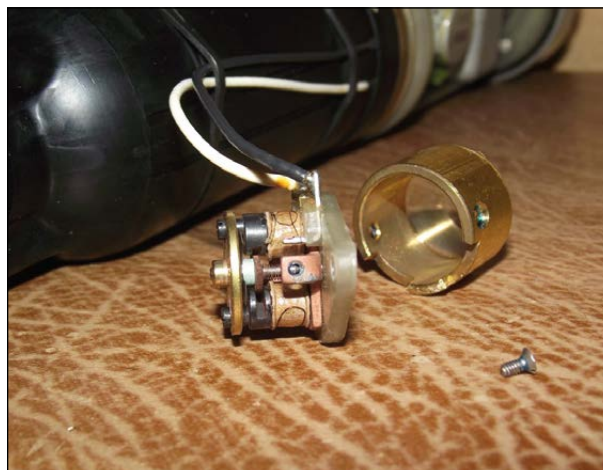
Рисунок 3 – Контрольный источник типа «Бленкер» Т-15, размещенный внутри блока детектирования приборов ИМД-21Б (БА, С, СА, СА-Р), ИМД-22 (БА, СА) (URL: http://im13.rhbz.org/albums/userpics/10001/cfSwXNQDNF8.jpg , http://im13.rhbz.org/albums/userpics/10001/xqxlG6mmUHU.jpg ; дата обращения: 17.06.2022)
