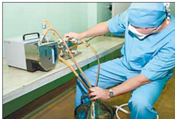
Рисунок 2 – Использование микрофилтрационной установки «Сартокон-мини» в отработке технологии получения чумных вакцин (фотография авторов)
