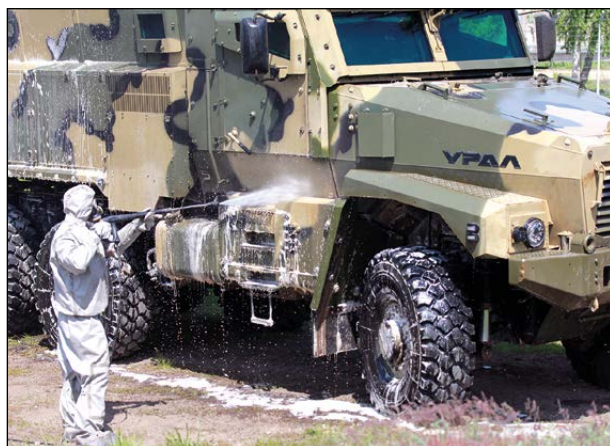
Рисунок 5 – Обработка объекта ВВСТ высоконапорной водяной струей. Авторство изображения принадлежит ФГБУ «33 ЦНИИ» Минобороны России
