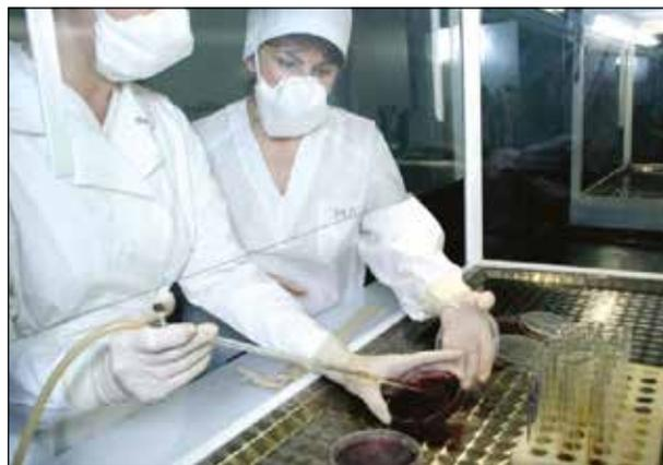
Рисунок 5 – Определение количества иммобилизованных микроорганизмов на носителе
