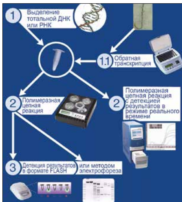
Рисунок 3 – Различные способы детекции результатов при осуществлении полимеразной цепной реакции (1 – выделение нуклеиновых кислот; 1.1 – обратная транскрипция; 2 – постановка классической ПЦР или ПЦР-РВ; 3 – детекция результатов в формате FLASH или методом электрофореза) 1
