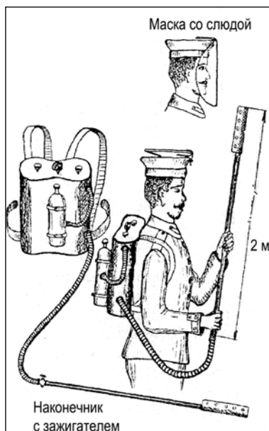
Рисунок 11 – Ранцевый огнемет Фидлера, продемонстрированный русским военным инженером на его опытной станции под Берлином 15 июля 1910 г. (ст. ст.) [1]. Но это не Kleif M.1912, принятый на вооружение германской армии через два года
