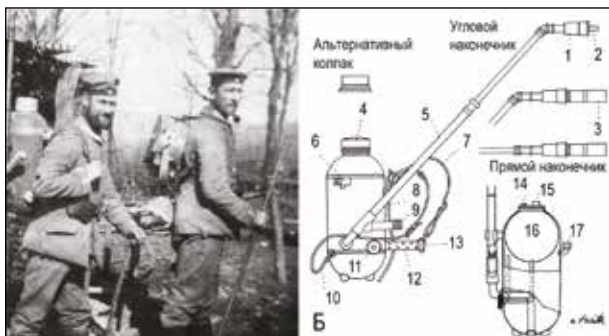
Рисунок 12 – Ранний Kleif M. 1912. А. Германский сапер с огнеметом Kleif M. 1912. Рядом сапер с укладкой для переноса зажигателей и наконечников для огнемета. Снимок сделан под Верденом ранее 1916 г. [3]. Б. Схематическое изображение Kleif M. 1912. 1) держатель воспламенителя (зажигателя); 2) форсунка; 3) воспламенитель с защитным чехлом; 4) резьбовой колпак; 5) телескопический брандспойт, прикрепленный к огнемету поворотным шарниром; 6) зажим для крепления брандспойта во время транспортировки огнемета; 7) кожаный плечевой ремень; 8) стальная несущая рама; 9) запорный клапан; 10) ремень; 11) клапан давления огнесмеси; 12) стальной упор для талии; 13) карабин; 14) колпачок баллона для сжатого газа; 15) манометр; 16) баллон для сжатого газа; 17) труба для заполнения огнесмесью. В большинстве моделей Клейфов баллон со сжатым газом встраивался в емкость с огнесмесью. Но были модели ранцевых огнеметов с наружным расположением такого баллона [6]
