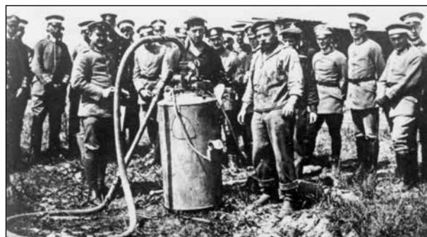
Рисунок 13 – Демонстрация германским офицерам огнемета Grof M. 1912. Баллон со сжатым газом лежит за спиной моряка [3]. На русском фронте огнеметы данного типа впервые были применены 17.10.1916 г. к северу от Барановичей в боях у Скробовского ручья [8]
