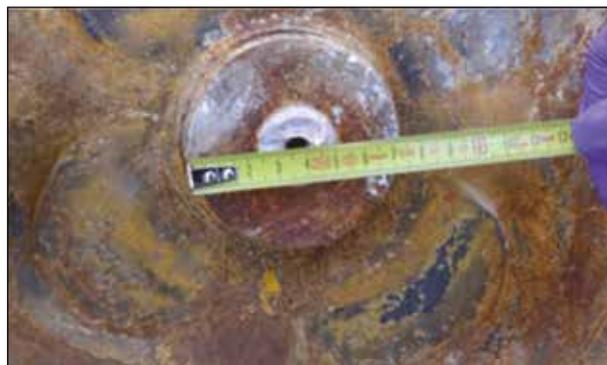
**Рисунок 19 – Ржавый баллон (рисунок 12 доклада).**
