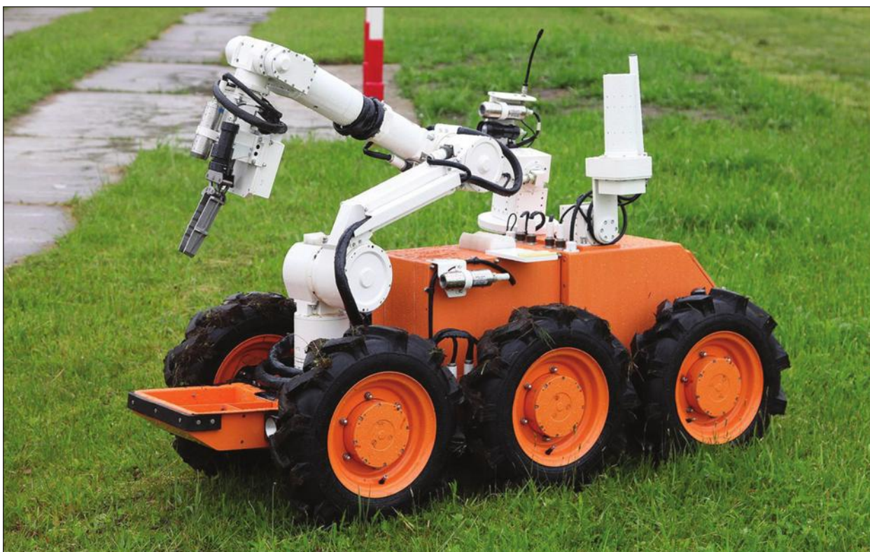
Робот, дистанционно управляемый, радиационной и химической разведки РД-РХР
