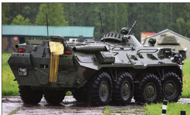
Разведывательная химическая машина РХМ-4
