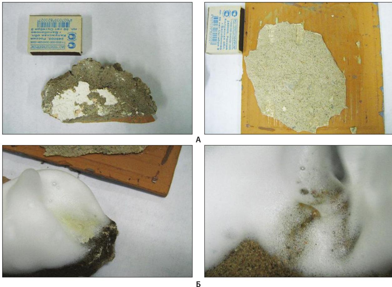
**Рисунок 7** — *Обработка твердой поверхности фермент содержащим пенным покрытием (А – Образцы штукатурки перед обработкой; Б – Образцы штукатурки после загрязнения параоксоном и обработки пеной с ферментом His<sub>6</sub>-ОФГ, полученной при помощи миксерной технологии)*
