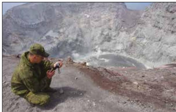
**Рисунок 17** — Определение уровня диоксида серы в воздухе на вершине кратера вулкана Сарычева. Использован аспиратор сильфонный АМ-0059 с индикаторной трубкой. Концентрация диоксида серы в воздухе – 17 мг/м<sup>3</sup>
