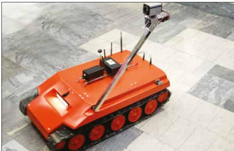
Робот предназначен для оценки потенциальной опасности различных объектов и территорий. Наличие дозиметра, газоанализатора и другой измерительной аппаратуры позволяет проводить экспресс-анализ, определять качественный и количественный состав примесей в воздухе, идентифици-
