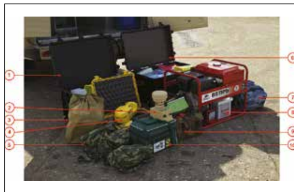
Рисунок 21 — Оборудование машины МБР (1 – Кофр с приборами и оборудование для анализа проб методами ПЦР и ПЦР-РВ. 2 – Модульный тактический коллектор С100. 3 – Прибор автономной бортовой для специальной обработки ДК-4. 4 – Пробоотборник аэрозолей BioCapture 650. 5 – Противогазы. 6 – Приборы и оборудование для электрофореза (при анализе проб методом ПЦР). 7 – Костюмы защитные «Корунд-2». 8 – Электростанция дизельная мощностью 5 кВт «Вепрь» АДП 5-230 ВЯ-БС. 9 – Комплект отбора проб. 10 – Термоконтейнер для хранения и доставки проб с герметичными контейнерами для проб)
