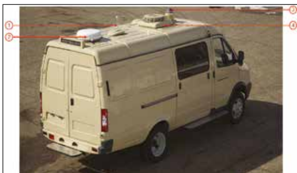
Рисунок 16 — Внешний вид машины МБР и размещение навесного оборудования (1 – Штанга воздухозаборника детектора аэрозолей IBAC. 2 – Антенна станции спутниковой связи Инмарсат BGAN Explorer 727. 3 – Обзорная камера видеонаблюдения AXIS Q6032-E. 4 – Кондиционер)
