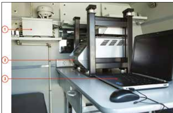
Рисунок 20 — Оборудование рабочего отсека машины МБР (1 – Сигнализатор биологических угроз в режиме реального времени ИВАС. 2 – Анализатор нуклеиновых кислот АНК-32. 3 – Ноутбук)
