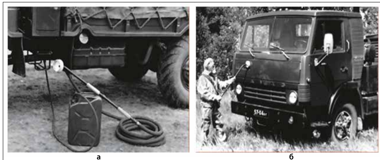
Рисунок 7 — Автомобильный комплект специальной обработки военной техники ДК-4 (а — общий вид комплекта ДК-4; б — дегазация автомобиля КАМАЗ ДК-4)
