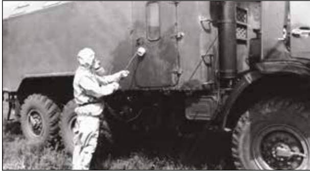
Рисунок 10 — Встроенный прибор специальной обработки (1 — компрессор автомобиля; 2 — рабочая емкость ВПСО; 3 — жидкостной рукав; 4 — ресивер автомобиля; 5 — брандспойт)
