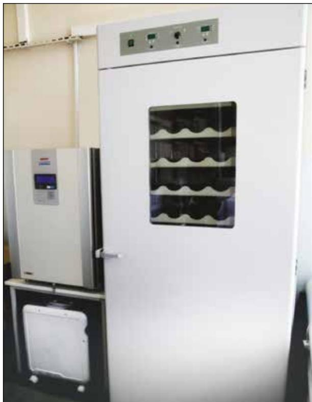
Рисунок 2 — CO<sub>2</sub>-инкубатор с объемом 170 л и роллерная установка
