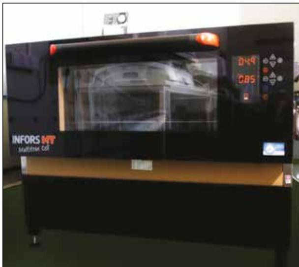
**Рисунок 3** — Шейкер-СО<sub>2</sub>-инкубатор Multitron Cell
