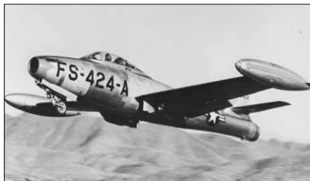
Рисунок 7 – Републик F-84 «Тандерджет» – американский одноместный одномоторный реактивный истребитель. Практическая дальность: 2420 км; крейсерская скорость: 783 км/ч. Мог нести под крылом две бомбы массой до 454 кг. Оборудование для диспергирования сухих бактериальных рецептур (два бака) было установлено в 1951 г. на неизвестное количество самолетов [3]. Фотография из https://en.wikipedia.org/wiki/Republic_F-84_Thunderjet (дата обращения: 20.11.2020)
