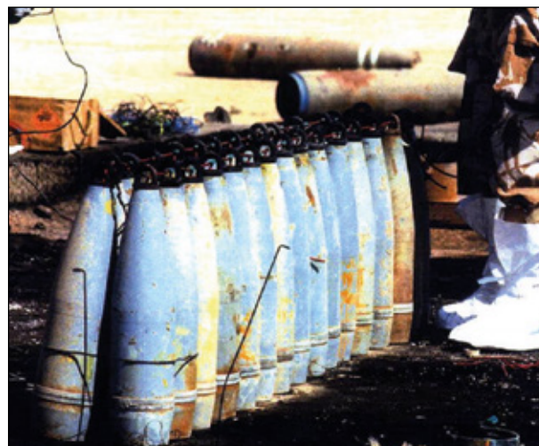
Рисунок 18 – 155-мм ипритные снаряды, подготовленные к открытию через трубку запального стакана [5]
