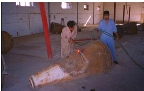
Рисунок 21 – Разрушение боеголовки ракеты «аль-Хусейн» [5]
