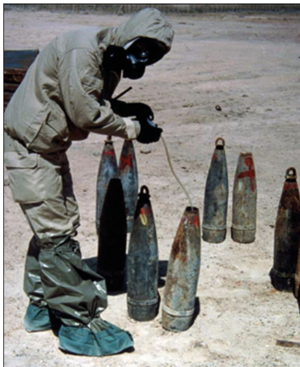
Рисунок 16 – Разборка 155-мм артиллерийских ипритных снарядов [5]
