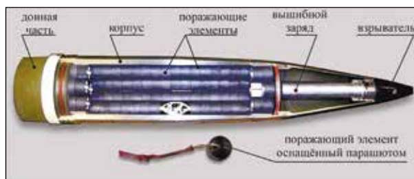
Рисунок 17 – Основные элементы устройства 155-мм артиллерийского снаряда нелетального действия XM1063 [12, 13]
